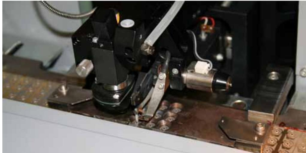
Abbildung zeigt die Modulproduktion für Smart Cards. Die Fertigung reicht von der eigenen Modulherstellung über Antennen- und Vorlaminatproduktion bis zur finalen, elektrisch geprüften und programmierten Karte mit kundenspezifischen Zusatzausstattungen. Die Cardag liefert dabei alles aus einer Hand.
